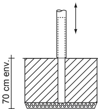
Mettre le tube de sol environ 70 cm dans le béton du fondement
